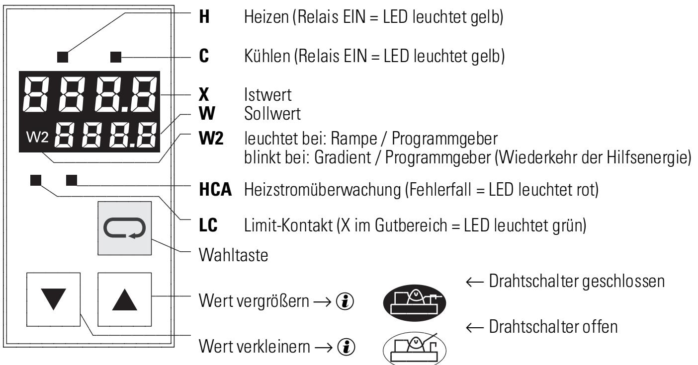
**i** Die Werte werden um so schneller geändert, je länger die Taste gedrückt wird. Dies gilt für Sollwerte, Parameter und Konfigurationen. Wir empfehlen, die alten Werte vor der Veränderung zu notieren.
