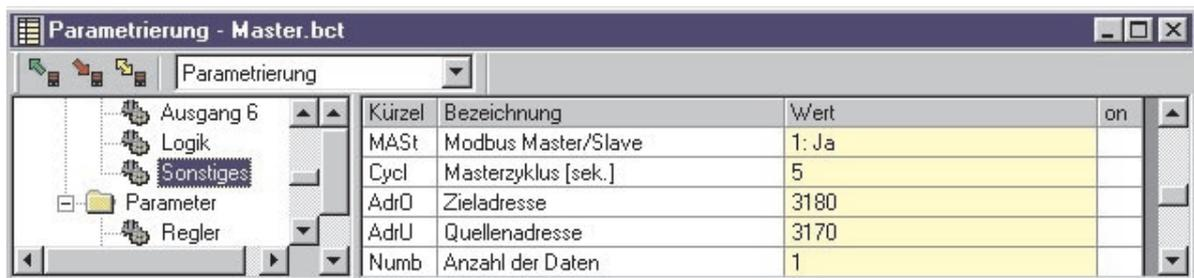
Im vorhergehenden Bild sehen Sie eine mögliche Konfiguration für einen MODBUS-Master. In diesem Beispiel wird der aktuelle Sollwert (Quellenadresse 3170) des Masters alle 5 Sekunden (Masterzyklus) an die Slaves (Zieladresse 3180) übertragen.
